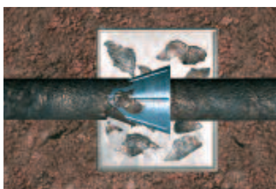
Pomocná stavební jáma se štípacím kuželem
