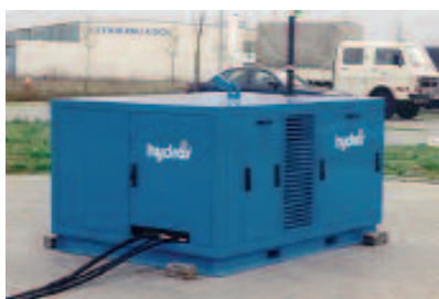
Hlukově izolovaný hydraulický agregát
