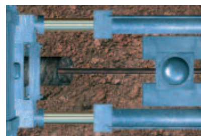
Cílová stavební jáma s tažným zařízením
