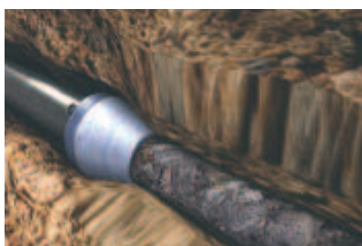
Umístění roztahovacího adaptéru mezi starou a novou rourou
