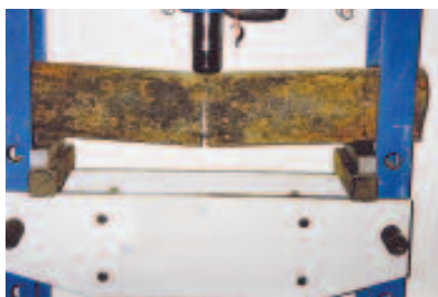
Simulace lomu trouby prováděná v rámci zkoušek kvality
