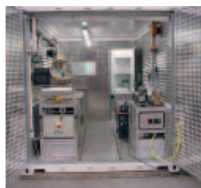
Zařízení pro inspekci televizní kamerou a laserovou kalibrací
