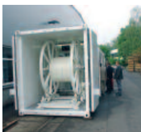
Klimatizovaný kontejner na lineární plnění lepidla
